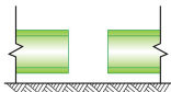
2. ตัดท่อบริเวณที่ถ่างท่อก่อน บริเวณที่จะติดตั้งจุดจ่ายน้ำเพิ่ม ให้แยกออกเป็นสองด้าน
