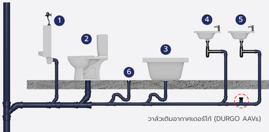
การใช้งานวาล์วเติมอากาศเดอริโก้ (DURGO AAVs) กับ 5 สุขภัณฑ์ + Floor Drain 1 จุด
